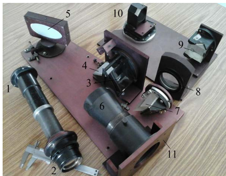
Рис.6. Элементы конструкции спектрофотометра. Обозначения: 1 – верхняя часть трубы коллиматора, крепится к нижней части узла деккера, 2 – объектив коллиматора, 3 – входная грань призмы Аббе, 4 – выходная грань призмы Аббе, 5 – эшелле, 6 – объектив камеры, 7÷10 – канал подзора звезды изнутри спектрофотометра, 11 – фланец крепления ПЗС-приемника спектрофотометра.
