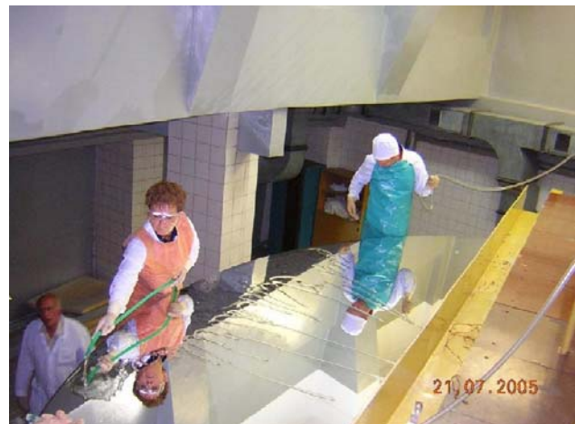
Рис. 15. Закрепление алюминиевого слоя. Fig. 15. Fixing the aluminium layer.
