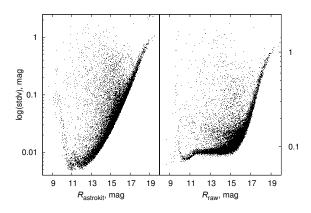
**Рис. 9.** Зависимость стандартного отклонения блеска звезд по всей серии наблюдений от звездной величины для исходных данных (справа) и для данных после обработки программой **Astrokit** (слева).
